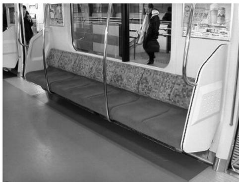
図1.3 近年の代表的な通勤鉄道車輦であるJR東日本のE233系のシート
